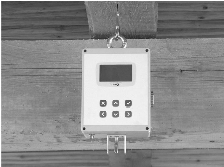
Si el tejado de un galpón es muy alto, suspenda una cadena entre el gancho y el anillo superior de la balanza.
