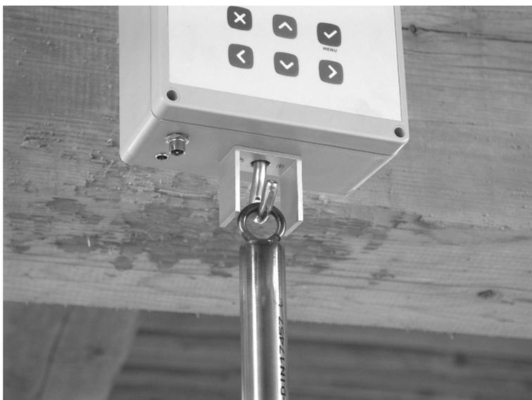
La varilla de la plataforma colgante está constituida por dos partes, de modo que se pueda ajustar continuamente de manera vertical al insertar las partes individuales entre ellas. Para fijar la longitud correcta siempre ajuste apropiadamente el tornillo en la varilla:
