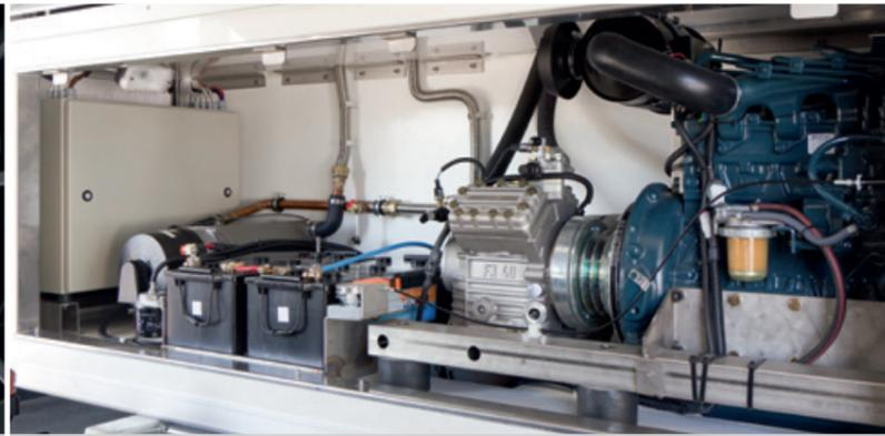
■ Tres capas de protección: EcoTransport, motor y baterías de respaldo.
