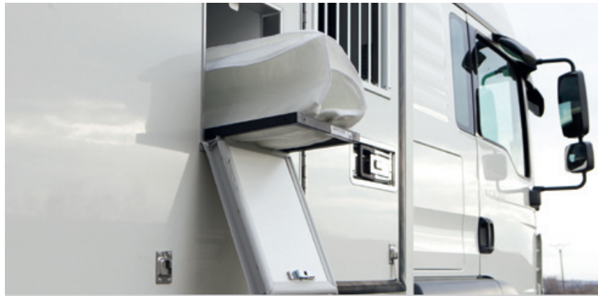
■ Einfach zugängliche Luftfilter erlauben längere Transporte.
